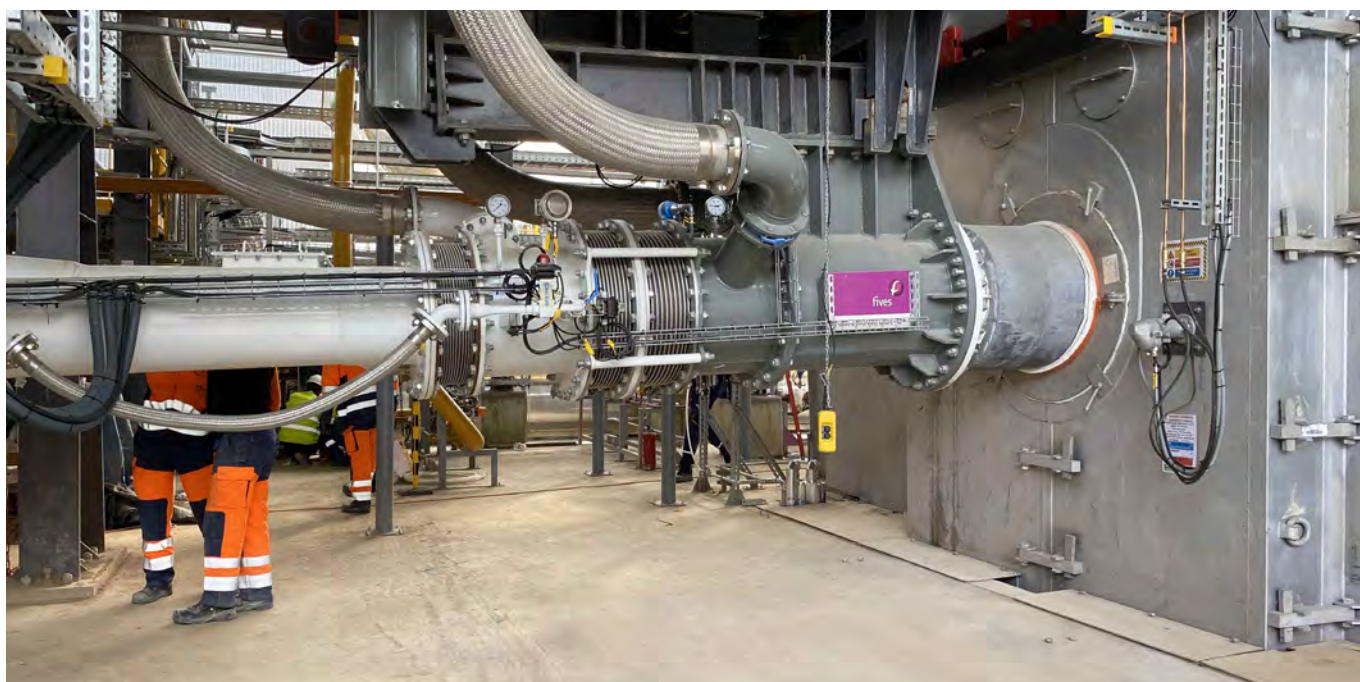
Tuyère du four 6 de la cimenterie d'Airvault : équipement clé assurant une partie de l'apport thermique nécessaire au procédé de fabrication du clinker.
