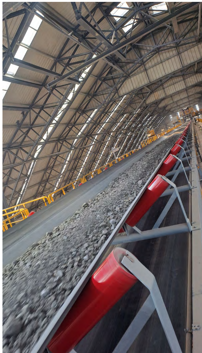
Tapis d'alimentation du hall de pré-homogénéisation : équipement dédié au transport des matières premières, calcaire et argile, utilisées dans le processus de fabrication du clinker.
